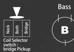
ブリッジピックアップはボディートップのミニ・スイッチによりハムバッカー・サウンドとシングルコイル・サウンドが切り替え可能です。SWをネック側に倒せば60'sシングルサウンド、ブリッジ側に倒せば70'sシングル・サウンド、そして中央で二つのコイルがバラレル・ハムバッカーで鳴るように配線されています。
